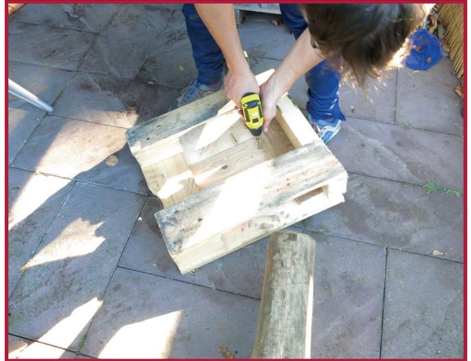
Jetzt sollte die Säule, die von dem alten Kratzbaum wiederverwertet wird, ebenfalls auf der Palette befestigt werden. Danach kann auch schon die erste Holzplatte auf der Säule festgeschraubt werden. Um diese auch doppelt zu sichern, empfiehlt es sich diese extra, mit einem Winkel an dem Baumstamm zu befestigen.
